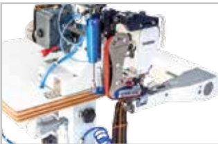
Çift çeker sistem Double pull system
