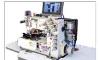
AB 321 Efka motor ve sürücü Efka motor AB 321 and driver system
