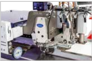
Step Motorla hassasiyeti artırılmış tela ünitesi Precision-enhanced interlining unit with stepper motor
