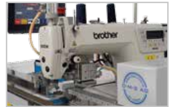
Vakum ünitesinin kumaşları sabitleme- siyle dikiş boylarında standarta ölçüler Standard dimensions in sewing lengths with vacuum unit fixing fabrics
