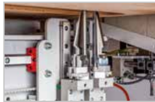
Step Motorla hassasiyeti artırılmış köşe bıçak sistemi Precision-enhanced corner knife system with stepper motor
