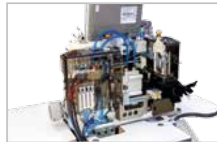
Saę-Sol baęımsız sökme sistemi Right-Left independent Ripping system
