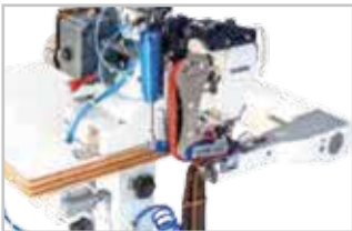
Çift çeker sistem Double pull system
