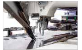
Step Motorla hassasiyeti artırılmış tela ünitesi Precision-enhanced interlining unit with stepper motor
