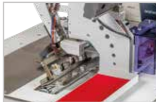
Step motorlu istiflemeye taşıyıcı tutucu Holder for stacking with stepper motor
