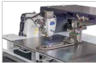
PS üzerinden serbest programlanabilir X Y servo motor sistemi Free programmable X Y servo motor system via PS
