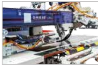
Hızlı makas ünitesi, özel tasarlanmış tutuculu istifleme sistemi Instant zipper knife cutting system
