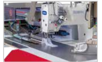
Cep dikiminde 20 mm'den 220 mm kadar çalışabilme özelliği Ability to work from 20 mm to 220 mm in pocket stitching
